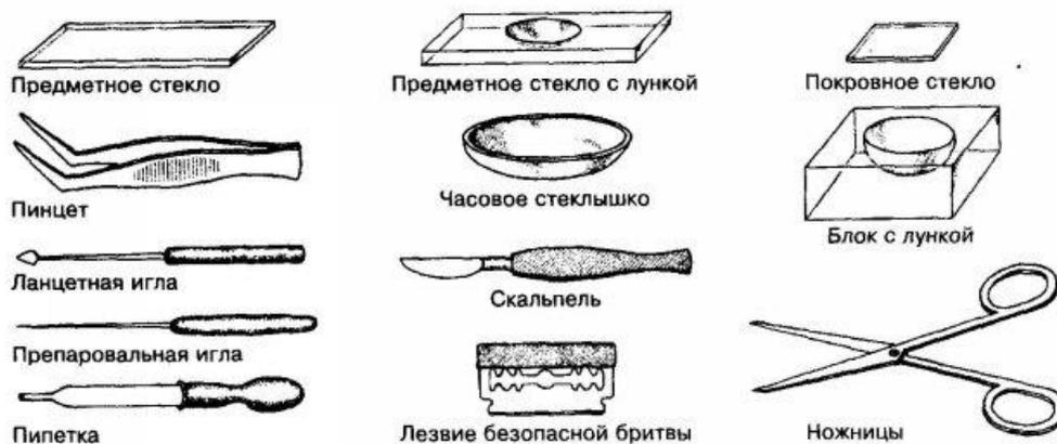
Рис.12. Инструменты для микроскопирования
